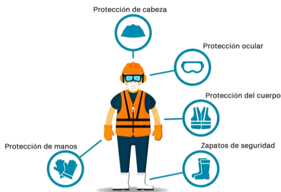
Ilustración 5. Equipos de Protección adecuado (EPPs)
